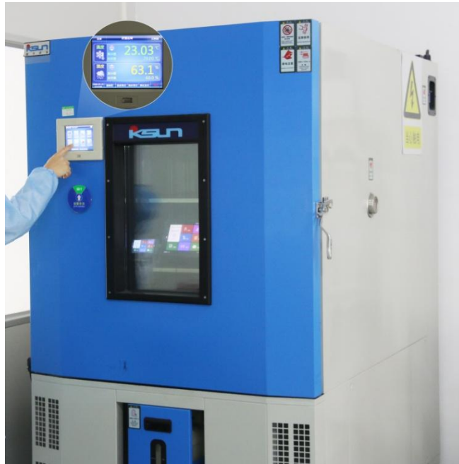
图 6-7 高低温老化测试图
